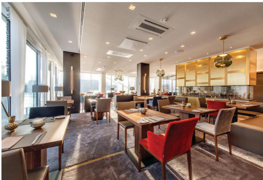
*Akustik. Im gesamten ersten OG wurden die Unterdecken mit Lochgipsplatten ausgeführt, die auf Wunsch des Bauherrn abschließend mit einem Akustikspritzputz beschichtet wurden.*
